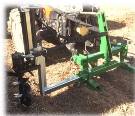
Rebsetzbohrer schwenkbar montiert
