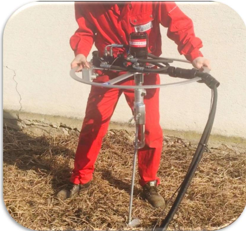
Zum Eindrehen von Telleranker. Mittels elektrisch, gesteuerten Ventilen werden die Bodenanker per Knopfdruck in das Erdreich gedreht.
