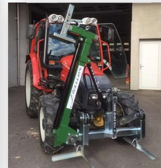
Der Pfahldrücker kann mit der universellen 3-Punktconsole an der Fronthydraulik oder an der Heckhydraulik verwendet werden. Natürlich ist es auch möglich, den Pfahldrücker an eine bestehende Console im Front- oder Zwischenachsbereich des Traktors zu montieren. Je nach Anforderungen wird der Pfahldrücker für Sie abgestimmt und gegebenenfalls angepasst.
