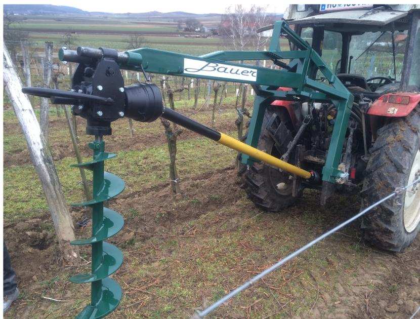
Der Bauer Erdbohrer ermöglicht eine spielend leichte **Aushebung von Erdlöchern**. Durch seine flexible Ausschwenkbarkeit können im Weingarten beide Seiten einer Reihe zeitsparend in einer Fahrtrichtung bearbeitet werden. Der Antrieb erfolgt mittels Gelenkwelle.
